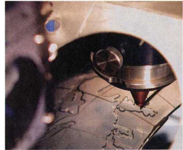
Berührungslos. Ein dünner Laserstrahl schneidet den Schirm auf den richtigen Ausschnitt zu und graviert die Rasterung.
